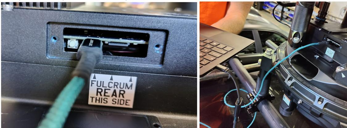
5. Con cuidado, presione el pequeño botón junto al puerto USB y manténgalo presionado mientras alguien enciende el sistema con el interruptor de alimentación principal del PSU. (Después de que el sistema se inicie, el controlador tendrá varios errores, pero los puede ignorar).
