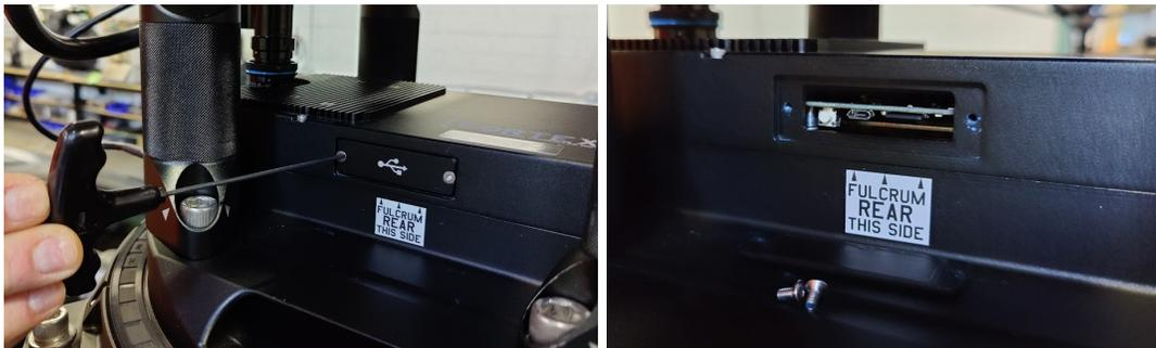
4. Conecte un cable micro-USB entre el puerto USB del CORTEX y el puerto USB de la computadora que se utilizará para la actualización.
